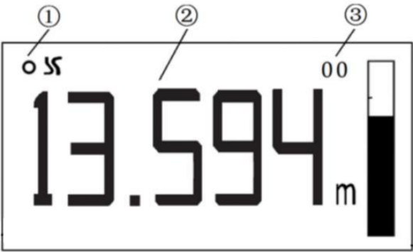
图 11-2 雷达物位计 LCD 主界面图
